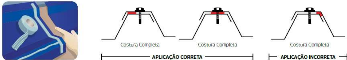
Aplicação correta da fita de vedação e do parafuso de fixação das telhas
